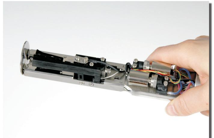
Schreibkopf mit selbstschließenden Ventilen
